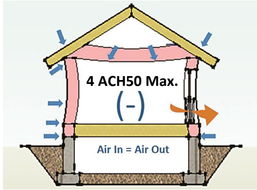
Depressurization Blower Door Test
